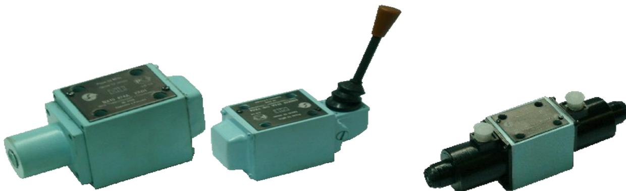
Гидрораспределители типа В10, 1Р10, РХ10 предназначены для изменения направления или пуска и останова рабочей жидкости в гидравлических системах. Область применения: станки, пресса, системы и устройства и автоматическим и полуавтоматическим циклом работы (ГАП, манипуляторы, станки с ЧПУ) и другие машины.
